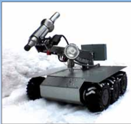
МРК-02 С ГИДРОРАЗРУШИТЕЛЕМ МАССА – 42 КГ; ДАЛЬНОСТЬ РАДИОУПРАВЛЕНИЯ – 400 М; АВТОНОМНАЯ РАБОТА – 4 Ч.
