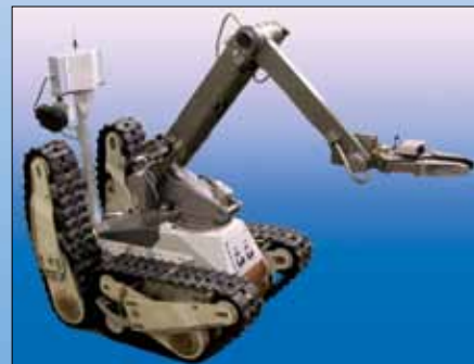
МРК-35 ДЛЯ ЭКСПЛУАТАЦИИ В ПОМЕЩЕНИЯХ ОГРАНИЧЕННОГО ОБЪЕМА. МАССА – 325 КГ; ДАЛЬНОСТЬ РАДИОУПРАВЛЕНИЯ – 500 М; АВТОНОМНАЯ РАБОТА – 4 Ч.
