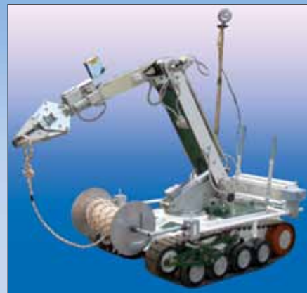
МРК-27 С БУКСИРОВОЧНЫМ КАНАТОМ МАССА – 165 КГ; ДАЛЬНОСТЬ РАДИОУПРАВЛЕНИЯ – 500 М; АВТОНОМНАЯ РАБОТА – 4 Ч.
