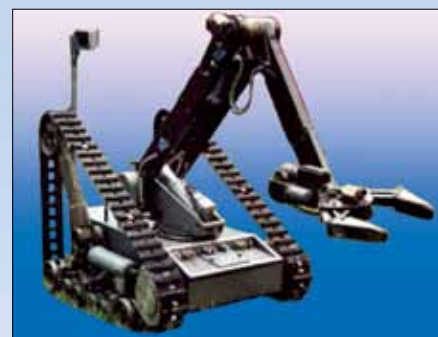
МРК-25 ДЛЯ ЭКСПЛУАТАЦИИ В ПОМЕЩЕНИЯХ ОГРАНИЧЕННОГО ОБЪЕМА. МАССА – 170 КГ; ДАЛЬНОСТЬ РАДИОУПРАВЛЕНИЯ – 500 М; АВТОНОМНАЯ РАБОТА – 4 Ч.
