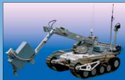
МРК-27 ПП ДЛЯ ОБНАРУЖЕНИЯ И ИДЕНТИФИКАЦИИ ВЗРЫВООПАСНЫХ ПРЕДМЕТОВ И ВЕЩЕСТВ. МАССА – 150 КГ; ДАЛЬНОСТЬ РАДИОУПРАВЛЕНИЯ – 500 М; АВТОНОМНАЯ РАБОТА – 4 Ч.
